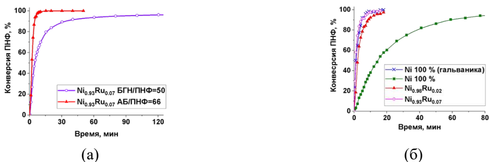
Рис. 2. (а) Влияние природы гидрида и (б) состава и способа приготовления катализатора на скорость гидрирования ПНФ (на рисунке отношение гидрида к ПНФ указаны в молях).
