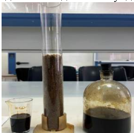
Рис. 1. Процесс добавление нефти в образец земли для определения скорости проникновения
