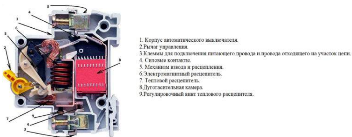
Рис. 1. Типовое устройство автоматического выключателя
