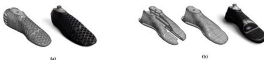
Рисунок 1. 3D модели и фотографии изготовленных протезов стопы: (a) Модель 1; (b) Модель 2
