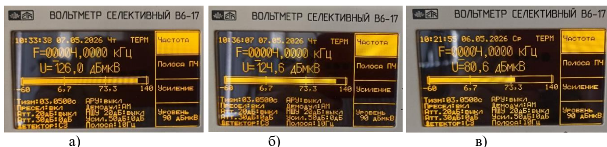
Рисунок 2. Внешний вид экрана селективного микровольтметра В6-17 при измерении уровней модуляционных составляющих тестовых сигналов (частота сигнала ВЧ-навязывания – 230 МГц, мощность генератора ВЧ-сигнала – 25 дБм, уровень тестового акустического сигнала – максимальный, частота тестового акустического сигнала – 4 кГц): VBW= 30 кГц (а), VBW= 10 кГц (б), VBW=3 кГц (в)
