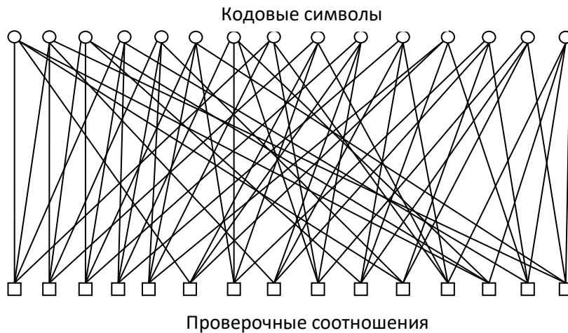
Рисунок 2 Граф Таннера проверок минимального веса кода БЧХ(15,7,5)
