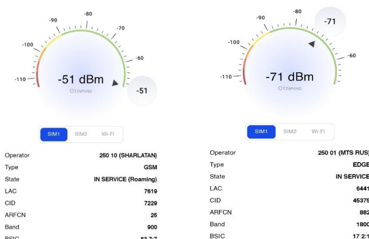
Рисунок 3 – Сравнение мощностей GSM-сигнала имитатора и базовой станции сотового оператора
