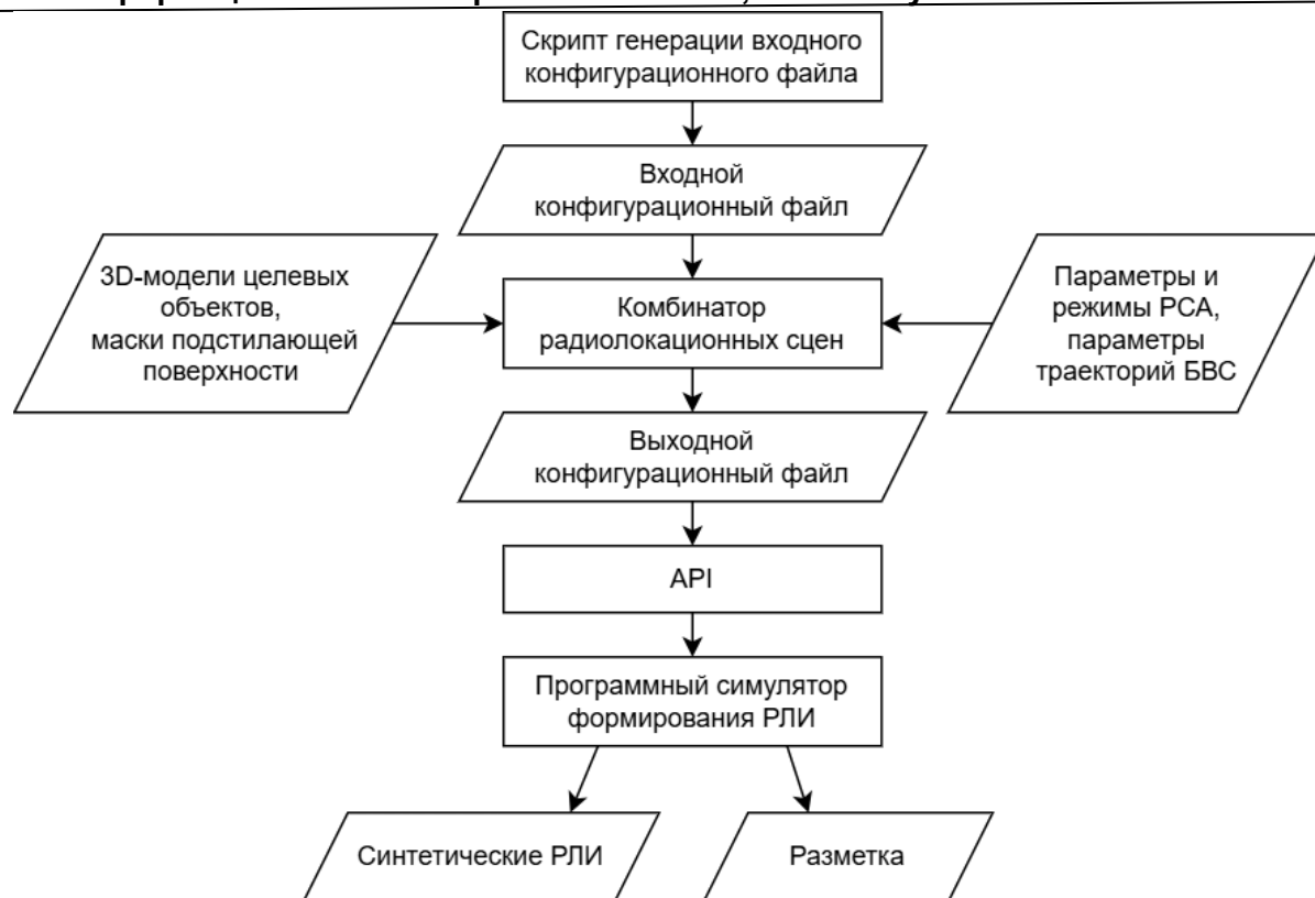
Рисунок 1 – Конвейер автоматизированной генерации синтетических РЛИ
