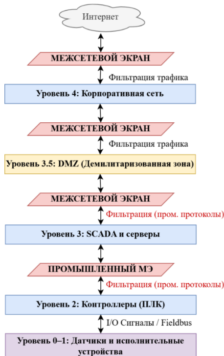
Рисунок 2 – Модель обеспечения защищенности технологической сети АСУ ТП с применением сегментации и промышленного МЭ
