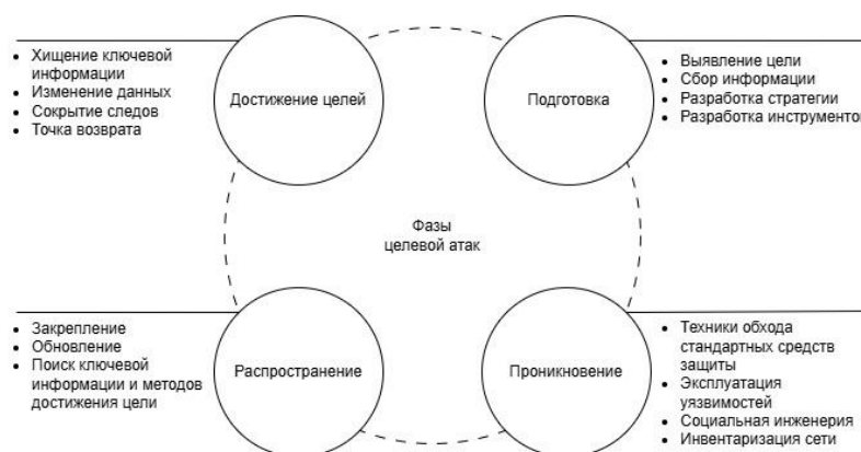
Рисунок 4 – Жизненный цикл компьютерной атаки
