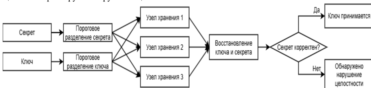
Рисунок 3 - Схема верификации ключа через секрет
