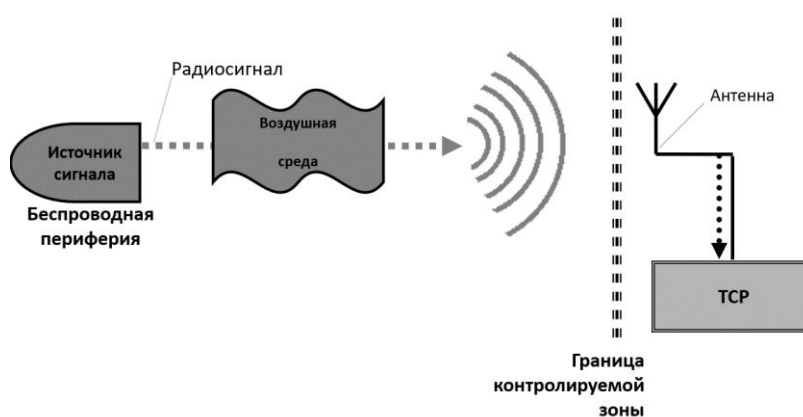
Рисунок 1. Схема канала утечки информации, реализуемого посредством пассивного перехвата радиосигнала
