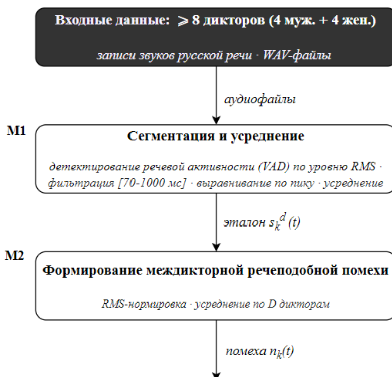
Рисунок 3 - Структура программного комплекса подготовки речеподобных помех и стимулов
