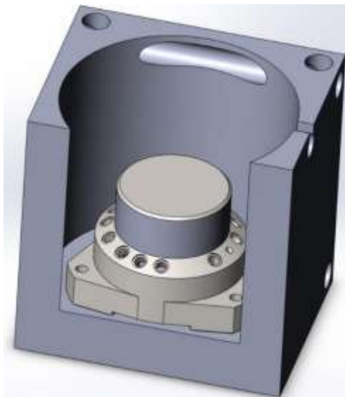
Рисунок 3 – Акселерометр, установленный в кубе
