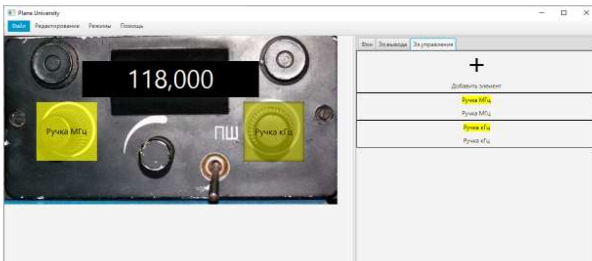
Рисунок 3 – Интерфейс программы универсального проектирования процедурных тренажеров авиационного оборудования в режиме редактирования
