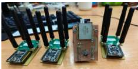
Рисунок 1а (слева) – навигационный модуль на база DW3000, 1б (справа) – навигационный модуль на базе МК8000
