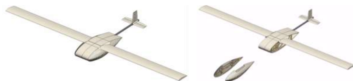
Рисунок 5 – Отделение быстросъёмных баков от планера БПЛА
