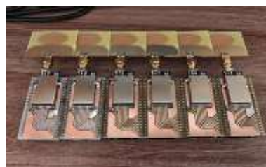
Рисунок 1а (слева) – навигационный модуль на база DW3000, 1б (справа) – навигационный модуль на базе МК8000
