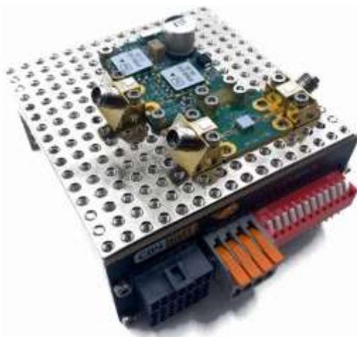
Рисунок 2 – Фото измерительного тракта iPA-72-MB с системой управления питанием iPWR
