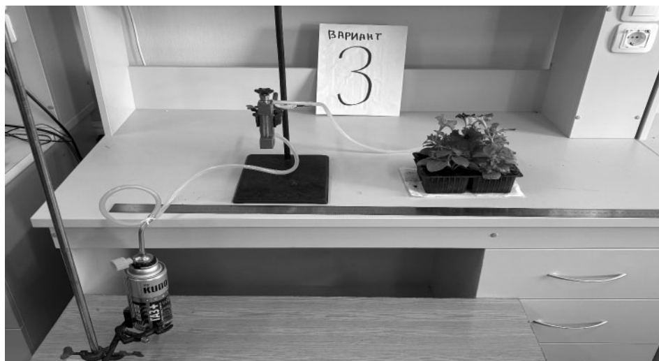
Рис. 3. Третий вариант опытов – выращивание рассады петунии с газификацией почвы пропан-бутаном через день нормой расхода 0,01 \text{ м}^3 в день.
