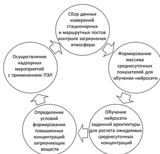
Рис. 1. Схема применения нейросетевой модели для информационной поддержки надзорных мероприятий
