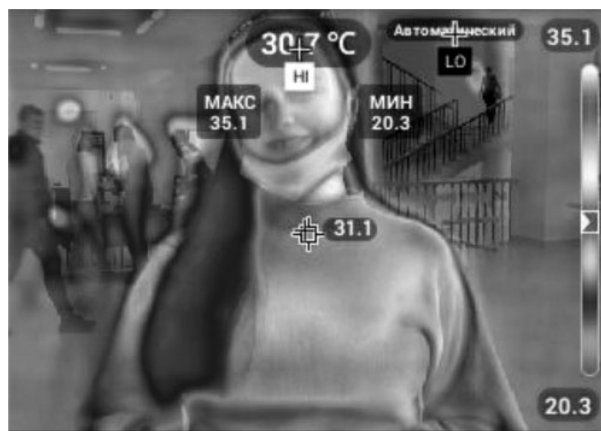
Рис. 1. Термограмма распределения температуры на поверхности кожи и одежды человека ( t_{\text{пом}} = 25\text{ }^{\circ}\text{C} ; \varepsilon_{\text{ср}} = 0,98 )
