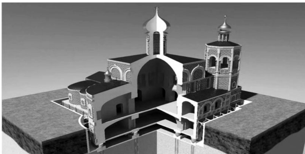
Рис. 2. Храм всех Святых на Кулишках. Схема, разрез с юго-восточной стороны
