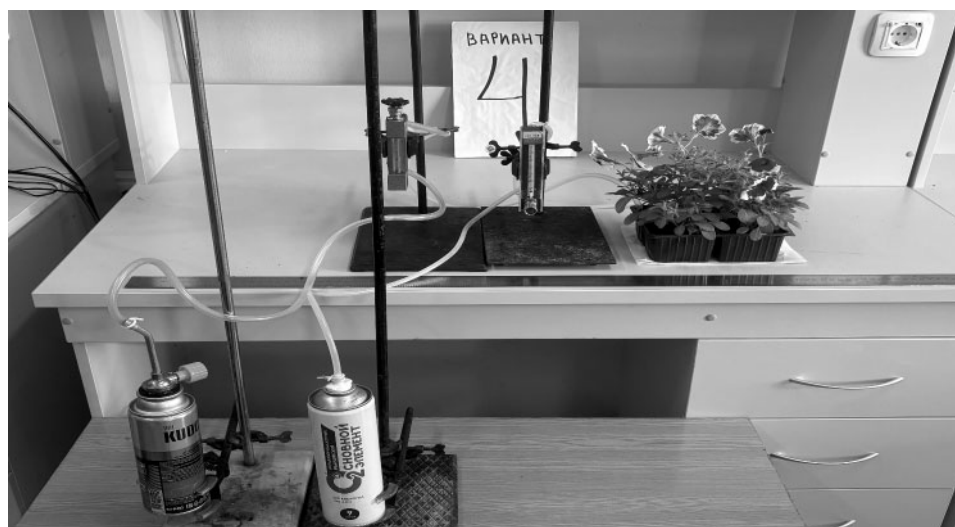
Рис. 4. Четвертый вариант опытов – выращивание рассады петунии с газификацией почвы кислородом по нечетным дням нормой расхода 0,01 \text{ м}^3 в день, а по четным дням пропан-бутаном нормой расхода 0,01 \text{ м}^3 в день.
